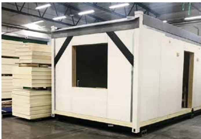
Figur 1: Byggnation av modul med ZIP-sandwichelement.
